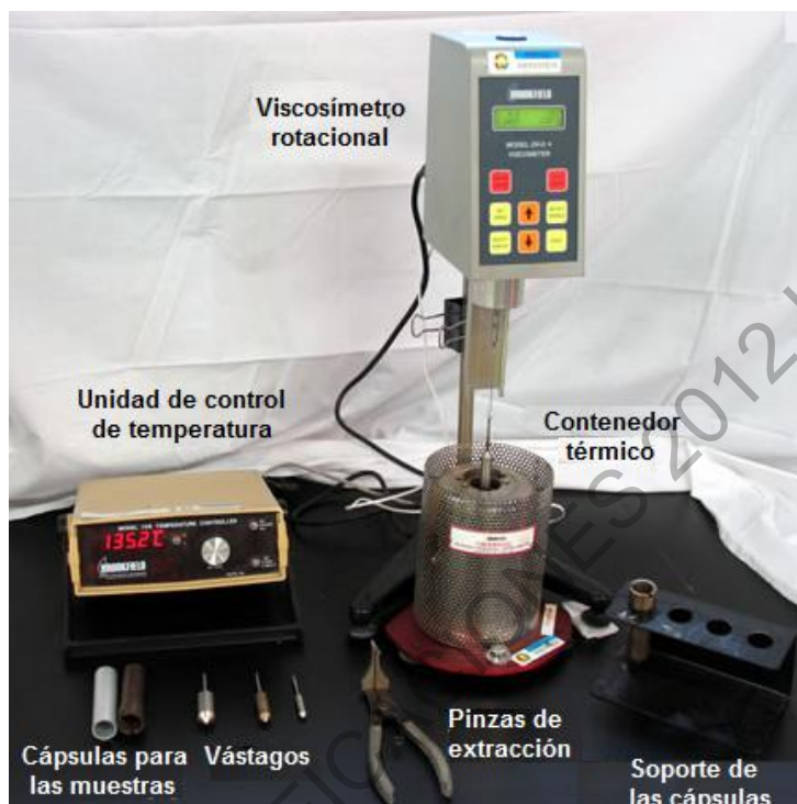
Figura 717 - 1. Elementos para determinar la viscosidad empleando el viscosímetro rotacional
